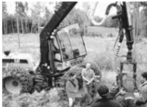
写真1：間伐や木材収穫に使う大型機械・ハーベスタ。オペレータは職人的な森林技術者。
